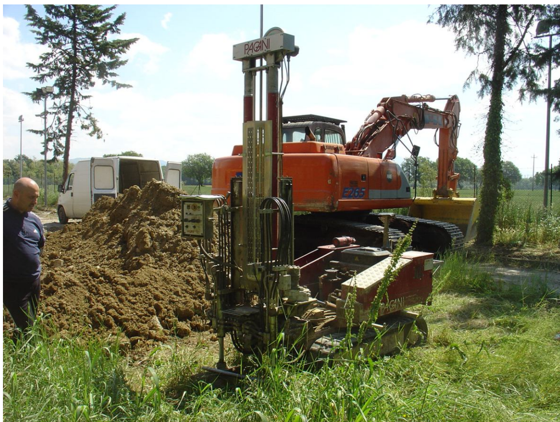
FOTO 1 : Strumentazione utilizzata per l'esecuzione della prova DPSH 1.
